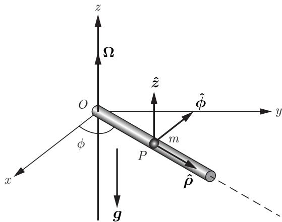
On considère une centrifugeuse constituée d'un tube tournant dans un plan horizontal avec une vitesse angulaire constante  $\Omega = \Omega \hat{z}$  autour de son extrémité située à l'origine  $O$  dans le plan horizontal  $Oxy$ . Une bille de masse  $m$ , considérée comme un point matériel  $P$ , est astreinte à glisser le long du tube.
